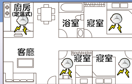
公寓大廈場所中 住宅用火災警報器(圖例)
