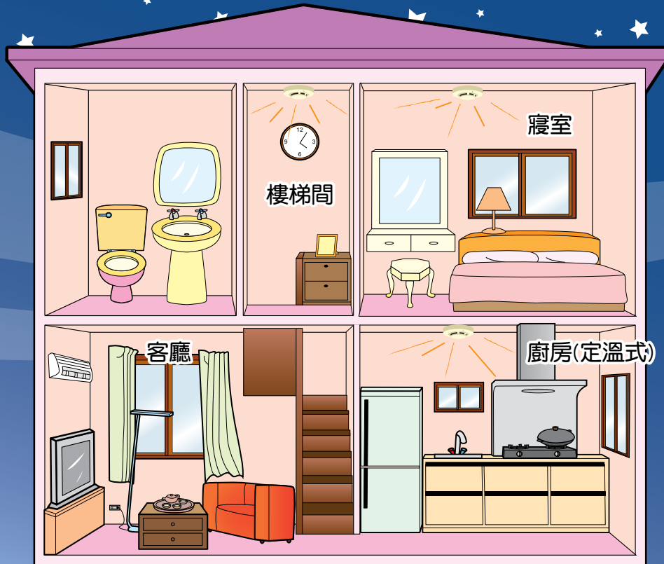
透天住宅場所中裝設住宅用火災警報器(圖例)
